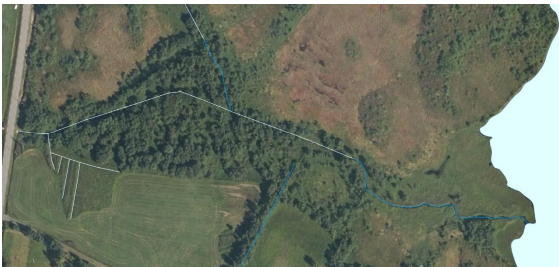
Figur 21. Bekken fra Veggemoveien og ned til Langmovatnet er et tydelig eksempel på kanalisering i nyere tid. Men det er også et område hvor det bør være mulig å remeandre. (Fra gardskart.nibio.no)
